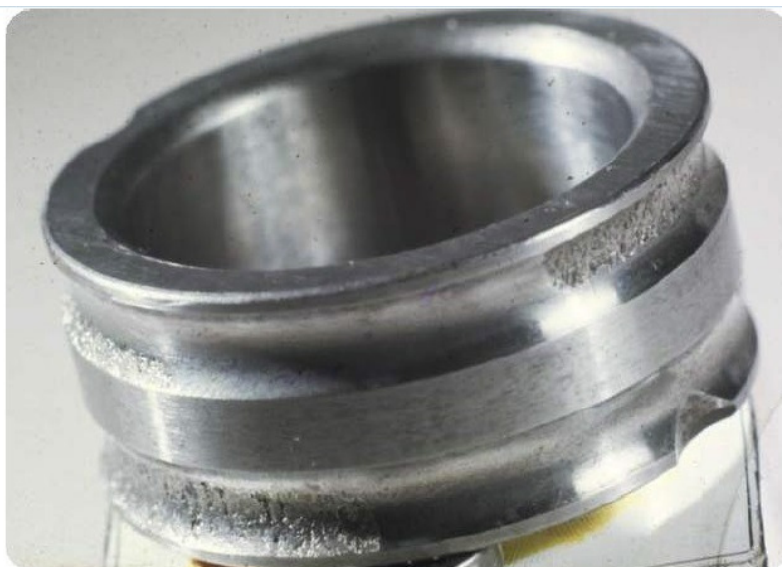
شکل ۴- شکست بیرینگ در اثر ناهمراستایی
