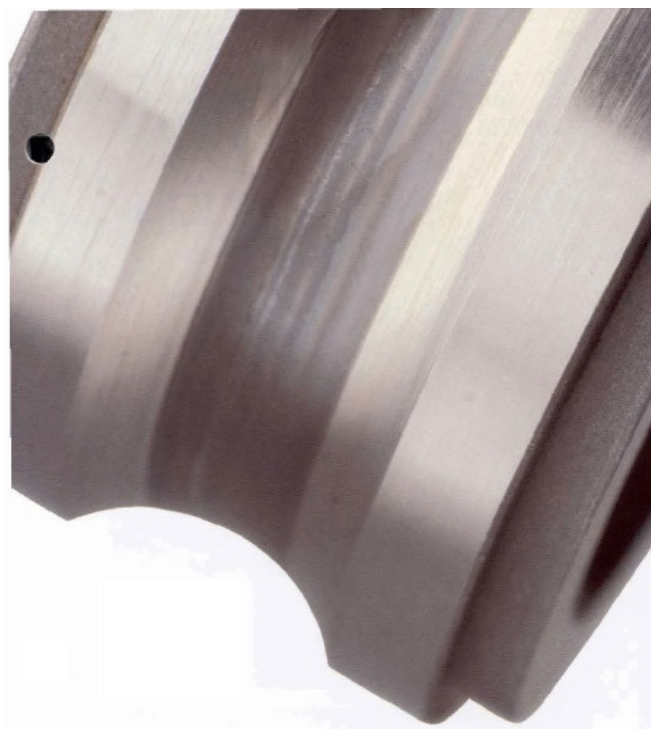
شکل ۳- ساییش شدید در مسیر حرکت ساچمه، در اثر نصب نادرست و انطباق خیلی سفت
